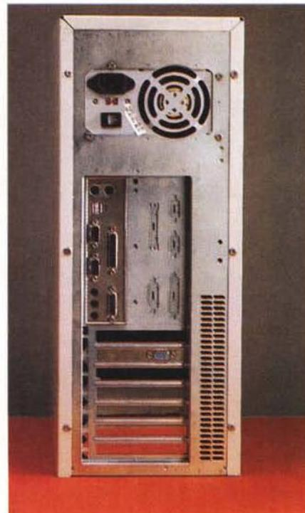
L'imponente cabinet tower del Laris 400: non si tratta solo di una scelta tendente ad offrire buone possibilità di ampliamento della configurazione, ma anche una conseguenza dell'ingombro delle nuove schede ATX che si fa decisamente sentire.
